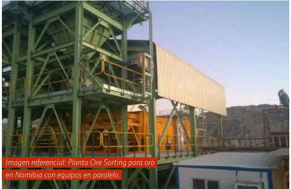
Imagen referencial: Planta Ore Sorting para oro en Namibia con equipos en paralelo.
