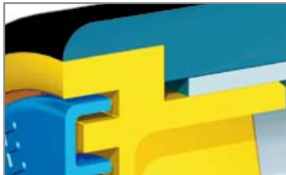
Una gruesa funda de HDPE de 12 mm de espesor, resistente a la abrasión y a la corrosión
